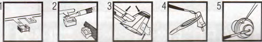
1 Entfernen des Chroms und der Farbe von den Kontaktflächen. 2 Reinigen der Kunststoffteile in einer milden Seifenlösung und an der Luft trocknen lassen. 3 Klebstoff auf die Klebeflächen auftragen. 4 Klebstoff gut durchtrocknen lassen. 5 Die Klebeflächen mit dem Klebstoff befeuchten und die Klebeflächen mit dem Klebstoff befeuchten.
