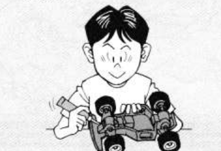
⑧ ギヤや軸受け部、サスペンションなどの可動部はグリスをさしておきましょう。
