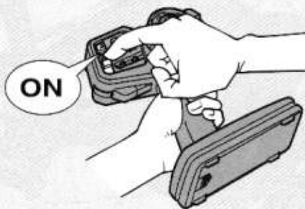
① 送信機のアンテナをのぼし、スイッチをONにします。
